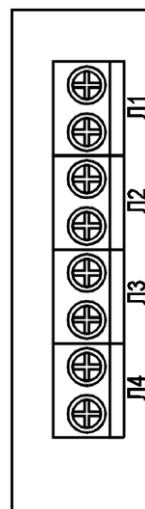
Рисунок 1.5 - Расположение колодок зажимов на плате коммутатора
